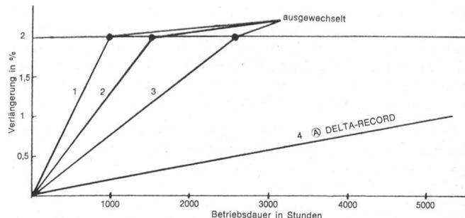
Die nebenstehende graphische Darstellung faßt Resultate mit SEDIS-Ketten «Delta-Record» zusammen, welche auf einer Textilmaschine beim Antrieb des Streckzylinders gemacht wurden. Kettendimension: einfache Kette  $9,525 \times 6,35 \times 5,72$ .
