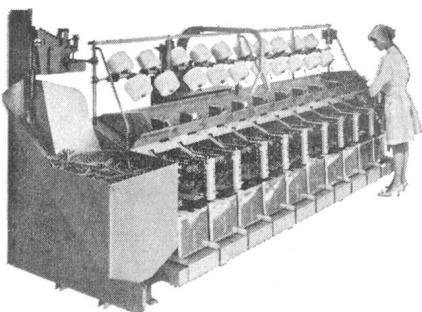
gleich schön, gleich gut und abschlagsicher gewickelt, ohne das Garn zu beanspruchen, mit 12000 UpM, auf dem leistungsfähigen und kostensparenden NON STOP-Automaten von Schärer
