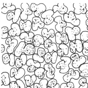
Abb. 6: Orlon 21, Zweikomponenten-Acrylfaser (eine Komponente leicht matted). Querschnittszeichnung 300:1
