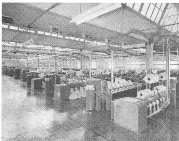
Kämmaschinen mit Abgangsabsaugung, im Hintergrund Strecken
