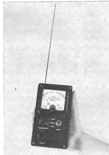
Zur Feststellung und Auffindung der statischen Elektrizität verwenden Sie Herbert Statitector
