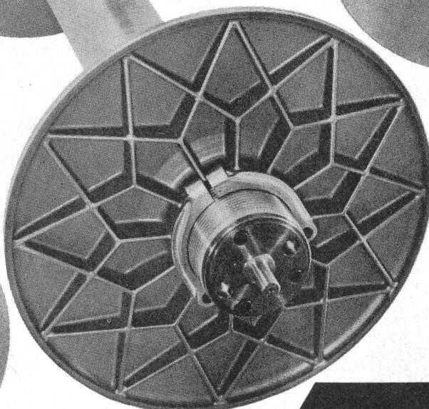
Gewinde-Kettbäume für höchste Beanspruchung, Rohr wahlweise in Leichtmetall oder Stahl
