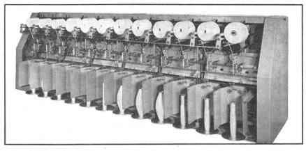
råzisions-Kreuzspulmaschine für Reyon und synthetische Fäden n 100-2000 den., Hublängen von 150 oder 200 mm, r konische oder zylindrische Kreuzspulen mit geraden Stirnflächen und rossem Garninhalt, raumsparende Maschinenteilung von 300 mm.
