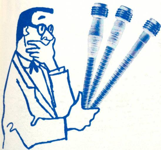
Zu früh gewchselte oder ausgelaufene Schussspulen verursachen hohe Abfallkosten oder kostspielige Gewebefehler. Dies verhindert zuverlässig der Loepfe-Fühler. Das Radarprinzip der Optik erfasst genau den richtigen, einstellbaren Moment für den Spulenwechsel.
