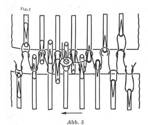
in der Nadelreihe auf beiden Seiten, d.h. auf dem vorderen und dem hinteren Nadelbett, welche zueinander Versetzt sind. Es wird folglich abwechslungsweise eine dadurch vorne, dann eine Masche hinten gebildet usw., dannet entsteht eine doppelflächige Ware (Abb. 5, Figuren 1 und 2).
