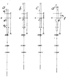
Abb. 21 Schema der Offenfachbildung bei der Jacquardmaschine nach Abb. 20; a = Tieffachstellung; b = Offenfachstellung aı auf d); c = Abdruckstellung bei Offenfach; d = Mittelstellung, die Messer begegnen sich
