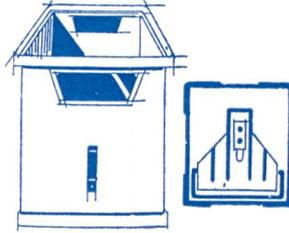
Schußspulenbehälter aus Kunststoff für Schärer- oder Schweiter-Spulautomaten, Rüti-Großmagazinautomaten, +GF+/ALV oder Saurer-Kastenlader (stapelbar, schlag- und bruchfest, form- und alterungsbeständig, für Spulenlängen 190, 200, 210 und 220 mm)
