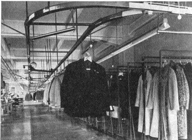
Kreisförderer für den rationellen Transport von Stückgütern jeglicher Art. Kreisförderer arbeiten zuverlässig, geräuschlos und brauchen wenig Kraft. Unsere Anlagen lassen sich jederzeit den gegebenen Verhältnissen anpassen; die Teile sind nach dem Baukastensystem gefertigt.
