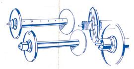
Kettbäume und Kettbaumscheiben aus Leichtmetall oder Stahl (Scheibenbefestigung durch Gewinde, Klemmkonus oder Backen); Zettelbäume aus Metall oder Holz
