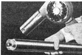
2. Heissluftgebläse gleichmässig über Schrumpfschlauch führen.
