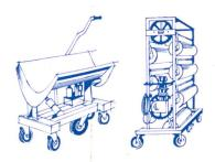
Hydr. Warenbaum-Hub- und Transportwagen System Schultheis für die verschiedensten Webmaschinenmodelle (Rüti, Saurer, Sulzer usw.) sowie Warenbaum-Sammelwagen für direkten Gewebeabzug in die Schau- oder Putzmaschine
