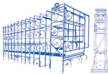
Kettbaum-Lagerständer System Schultheis (Einzel-, Doppel-, Etagen- oder Horizontalständer. Den jeweiligen Platzverhältnissen angepaßt). Spezialität: Leichte Verstellbarkeit der Tragestangen je nach Baumdurchmesser
