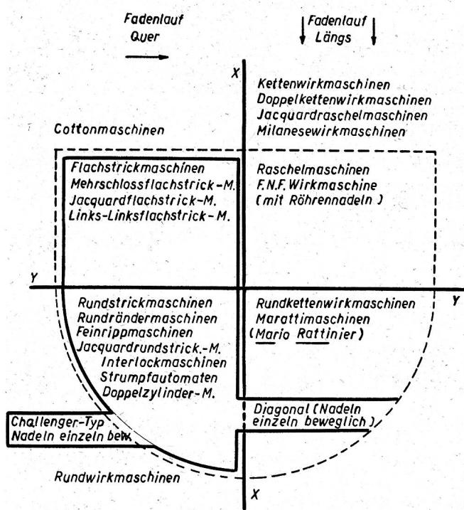
Die Achse X trennt die Maschinen nach dem Fadenlauf; links der Achse X = Fadenlauf quer oder in einer Spirale (bei Rundmaschinen). Bei den Maschinen rechts der Achse X erfolgt der Fadenlauf in Längs- oder Diagonalarichtung; hierbei ist vorwiegend eine Kette wie in der Weberei vorhanden.
