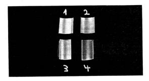
Bild 2. Ausschnitte aus Bronze- und Graugußlagern. 1 Fronze ungelaufen; 2 Bronze mit Sulfidschicht; 3 Grauguß ungelaufen; 4 Grauguß mit Sulfid- und Molybdändisulfidschicht.
