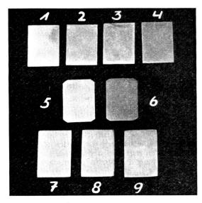
Bild 1. Einige Versuchsplättchen. 1 Kupfer geschliffen; 2 Kupfer mit verschieden starken Sulfidschichten; 3 Kupfer mit verschieden starken Sulfidschichten; 4 Kupfer mit einer Sulfid- und Molybdändisulfidschicht; 5 Grauguß geschliffen; 6 Grauguß mit Sulfidschicht; 7 Stahl geschliffen; 8 Stahl mit einer Sulfidschicht; 9 Stahl mit Sulfid- und stellenweise Molybdändisulfidschicht.
