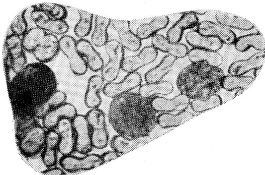
Abb. 8 Querschnitt eines Lycra/Orlon-Stapelgarnes (Mikrophoto) (Cliché NZZ)
