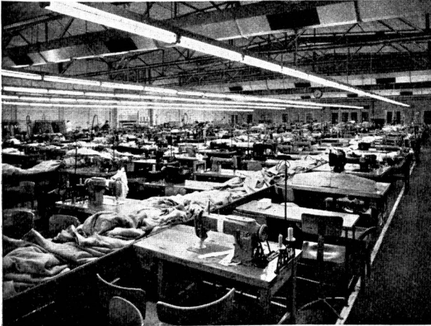
Abb. 1 Reine Allgemeinbeleuchtung durch gleichförmig strahlende Fluoreszenzleuchten
