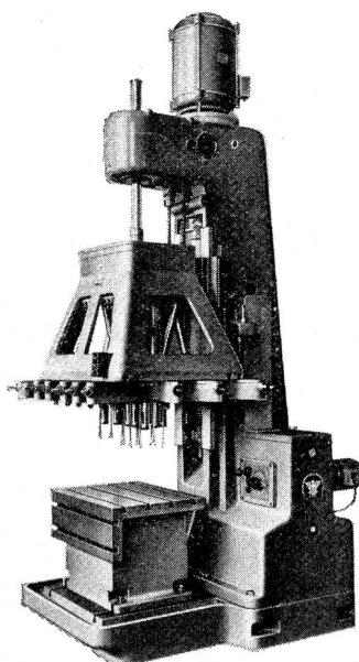
mit einzeln verstellbaren Bohrspindeln und hydraulischem Vorschubgetriebe.
