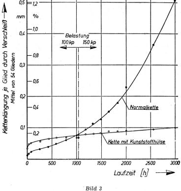
schleißfläche setzt sich aus dem Verschleiß an Bolzen und Hülse zusammen. Der Verschleiß an der zweiten Kette, welche mit Kunststoff-Gleitlagern ausgerüstet war, zeigt das Bild 2b. Hier ist deutlich die zwischen Bolzen und Stahlhülse liegende Kunststoff-Gleithülse erkennbar. Bolzen und Hülse zeigen ihre ursprüngliche Form. Der Verschleiß hat sich auf die Kunststoff-Gleithülse beschränkt. Die Verschleißgröße, gemessen an den Verschleißflächen, liegt bei weitem unter der der normalen Rollenkette.
