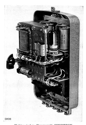
Elektronisches Steuergerät SENSITRON (Schutzdeckel entfernt)
