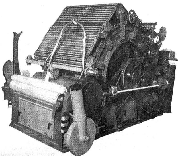
ergibt sich ein merklicher Vorteil der «Constant Card», indem die gesamte Ausstoßzeit um das 10—25fache vergrößert wird. Die in der Putzerei nicht ausgeschiedenen Abfallteile bestehen zur Hauptsache aus den kleinsten Schalenteilchen, welche dem Garn das unschöne Aussehen geben. Diese Teilchen sind sehr schwierig zu entfernen, da das Massengewicht sehr nahe an das Faser-Massengewicht herankommt und deshalb im Luftstrom die zu geringe Gewichtsdifferenz ein Abscheiden der Schalen-
