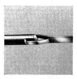
auges, die der Flachstahllitze in der Jacquardweberei zum Durchbruch verholfen hat. Wie in der Schaftweberei, wird auch hier der durchlaufende Kettfaden zu keiner Richtungsänderung gezwungen. Außerdem liegt der Faden im Fadenauge strichförmig auf; der spezifische Auflagedruck wird somit wesentlich reduziert. Diese beiden Punkte er-
