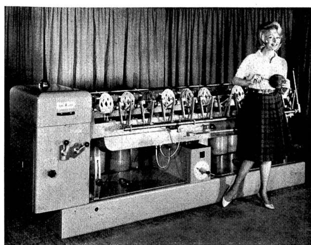
schlossenem Getriebekasten im Oelbad. Stahl- und Perlonräder ergeben einen geräuscharmen, wartungsfreien Lauf.
