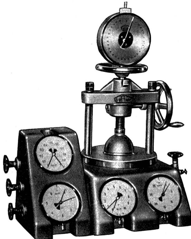
Die erforderliche Preßluft wird mittels Kompressor erzeugt oder einer Druckluftflasche entnommen. Zwischen Aufspannteller und Probe befindet sich eine Gummimembrane, die im Augenblick des Bruches durch eine Ventilklappe entlastet wird.
