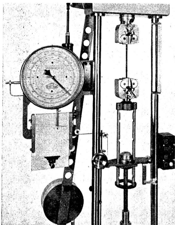
Klasse I von  $\pm 1\%$  von ein Zehntel des jeweiligen Meßbereiches an aufwärts. Das Ablesen der Prüfkraft ist an einer großen Kreisskala mit gestochen klarer Teilung möglich. Ein Schleppzeiger zeigt auch noch nachträglich den erreichten Höchstwert an. Beim Probenbruch wird der Pendelrückschlag durch eine Oelbremse gedämpft. Im geschlossenen Grundkasten ist das Regelgetriebe unter-
