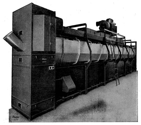
Abb. 6. Ansicht eines Rieter Mischautomaten.
