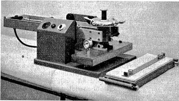
Der Bügeltisch ist um 90° versetzbar. Er ist mit einem Spezialgestell ausgerüstet, auf dem als Bügelunterlage ein perforiertes Bronzeblech und ein 2 cm dicker Bügelfilz angeordnet sind. Die Tischoberfläche ist mit Bohrungen und Wasserfangrinnen ausgerüstet. Dadurch kann der beim Bügeln auftretende kondensierte Wasserdampf ablaufen, und der Filz bleibt an der Bügeloberfläche nahezu trocken.
