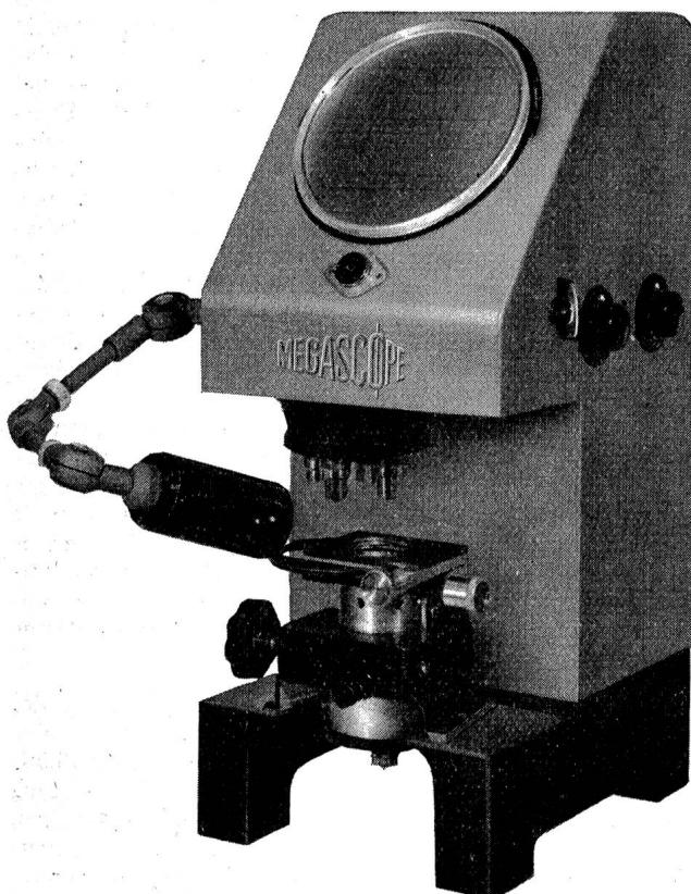
1.22 Das Auflicht (Episkopie) mit stufenloser Schaltung. Die Auflichtlampe sitzt auf einem leicht beweglichen Gelenkkarm und ermöglicht mittels des bequem verstellbaren Kondensors eine optimale Beleuchtung des Prüfgegenstandes. Das Auflicht bietet den großen Vorteil, das Prüfgut in einer außerordentlichen Plastizität auf der Mattscheibe wiederzugeben.
