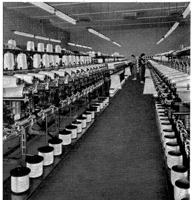
Präzisions-Kreuzspulmaschine «MONOFIL-KONER» zur Herstellung von Pineapple-Konen.
