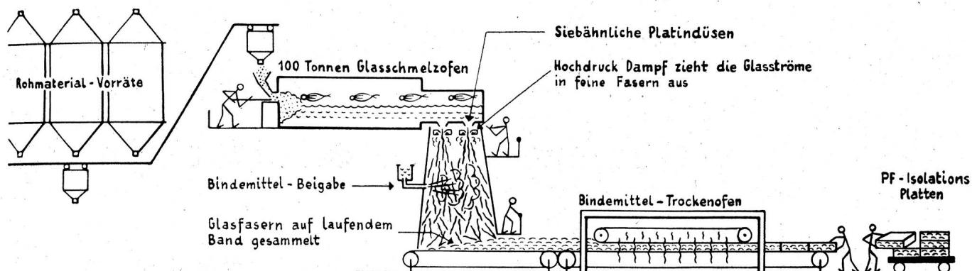
Die Aufgabe und das Ziel in der Herstellung von Glasfasern für Isolationswolle ist, wie schon die Beschreibung sagt, ein Isolationsmaterial. Zum Isolieren gegen Hitze, Kälte und Schall ist es unumgänglich, eine Unmenge einzelner Fasern zu erhalten. Zu diesem Zweck verwendet FIBERGLAS große Schmelzöfen, die von einer bis hundert Tonnen Rohmaterial aufnehmen und die täglich Tonnen über Tonnen verarbeiten.
