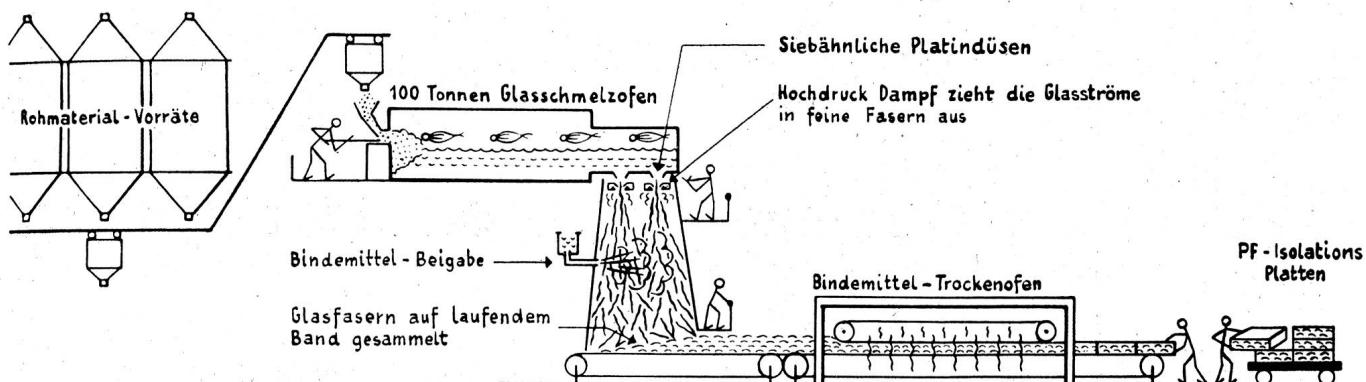
Die Aufgabe und das Ziel in der Herstellung von Glasfasern für Isolationswolle ist, wie schon die Beschreibung sagt, ein Isolationsmaterial. Zum Isolieren gegen Hitze, Kälte und Schall ist es unumgänglich, eine Unmenge einzelner Fasern zu erhalten. Zu diesem Zweck verwendet FIBERGLAS große Schmelzöfen, die von einer bis hundert Tonnen Rohmaterial aufnehmen und die täglich Tonnen über Tonnen verarbeiten.
