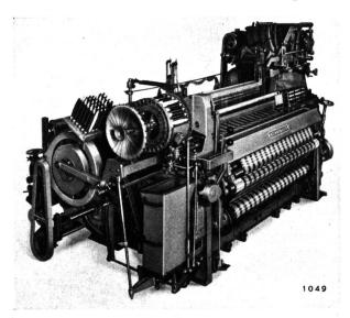
für 4 Farben Der neue Benninger/ +GF+ Spulenwechsel-Automat
