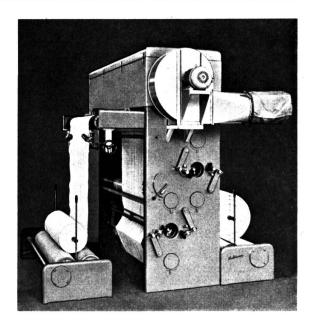
fachen Form sehr schöne Maschine je nach Artikel und je nach Möglichkeit, sie kontinuierlich mit einer genügenden Gewebemenge zu speisen, in 8 Arbeitsstunden bis zu 40 000 Metern und ist damit die Putzmaschine für Großwebereien, die in den Schersaal Sauberkeit und Hygiene bringt.
