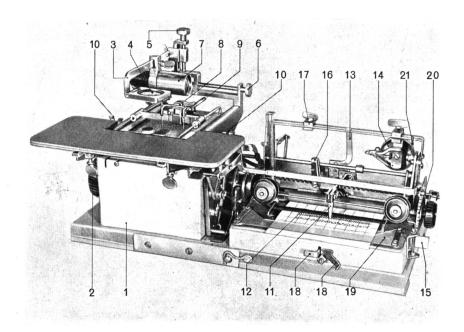
Liegt der Kettfaden unter dem Schußfaden, so ist der Steuerhebel 10 nach hinten zu stoßen und der Stempel bewegt sich um ein Feld vorwärts, ohne daß er auf das Farbband gedrückt wird. Es entsteht somit ein leeres Feld (gelassen).
