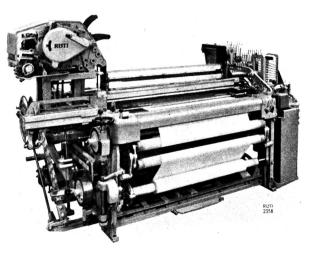
Zweischütziger Seidenwebautomat (Spulenwechsler) Wird auch als Schußmischer (mit einteiligem rundem Spulenmagazin) gebaut
