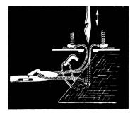
Der Schlaufensteller geht in die Ausgangslage zurück, und die Zungennadel gleitet mit den Fadenenden durch die Schlaufe und zieht die fertige Sonette fest.
