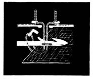
Die Zungennadel passiert die vom Schlaufensteller gehaltene Schlaufe und faßt vorne die beiden Fadenenden.
