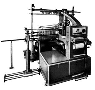
Automatische Geschirr-Einziehmaschine «Uster» Zellweger AG., Uster/ZH
