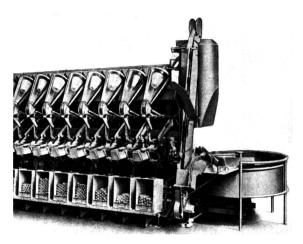
Super Schu $\beta$ -Spulautomat MSL mit Spulen-Abfüllapparat «Packer» Maschinenfabrik Schweiter AG., Horgen/ZH
