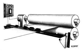
Dickenmeβ- und Regulieranlage für PVC-Folienwalzwerk. Meβköpfe mit radioaktiven Präparaten. Landis & Gyr AG., Zug
