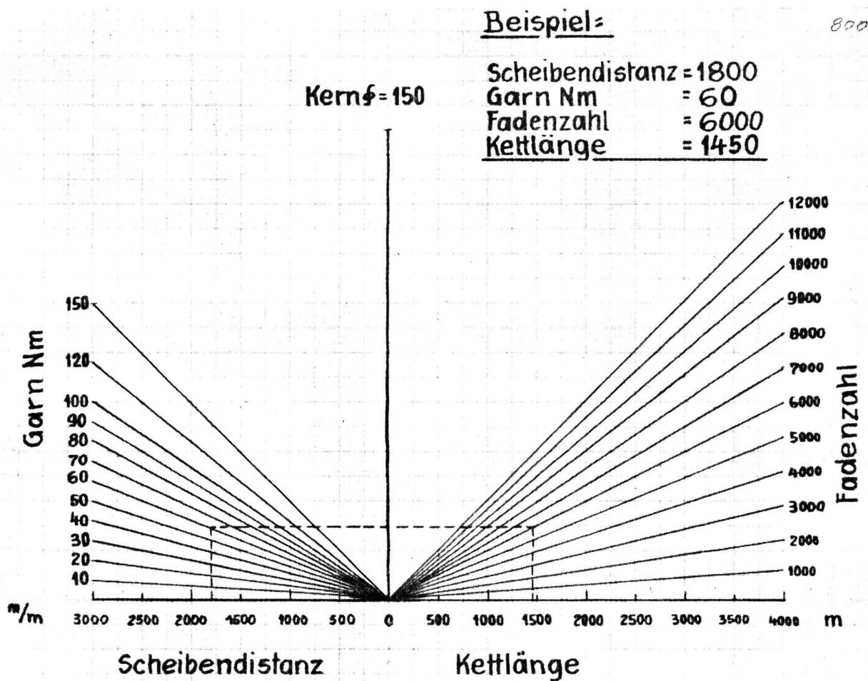
Bestimmung der Kettlänge in m für 500 m/m Scheiben- $\varnothing$ .
