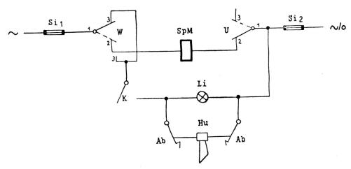
Elektro-Krempelwaage mit Elektro-Krempelsignal, Schaltbild mit Verdrahtung
