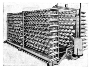
Rüti-Hochleistungs-Schärgatter mit «vacuum»-gesteuerten Fadenbremsen
