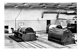
mel. Zum Messen der effektiven Schärbandlänge sowie der Stücklänge dient ein elektrischer Zähler. Dieser wird nur beim ersten Schärband benützt und ist durch einen Impulsgeber gesteuert, welcher durch eine, neben dem Schärband, direkt auf dem konischen Teil der kreisrunden Schärtrommel laufende Meßrolle angetrieben wird.
