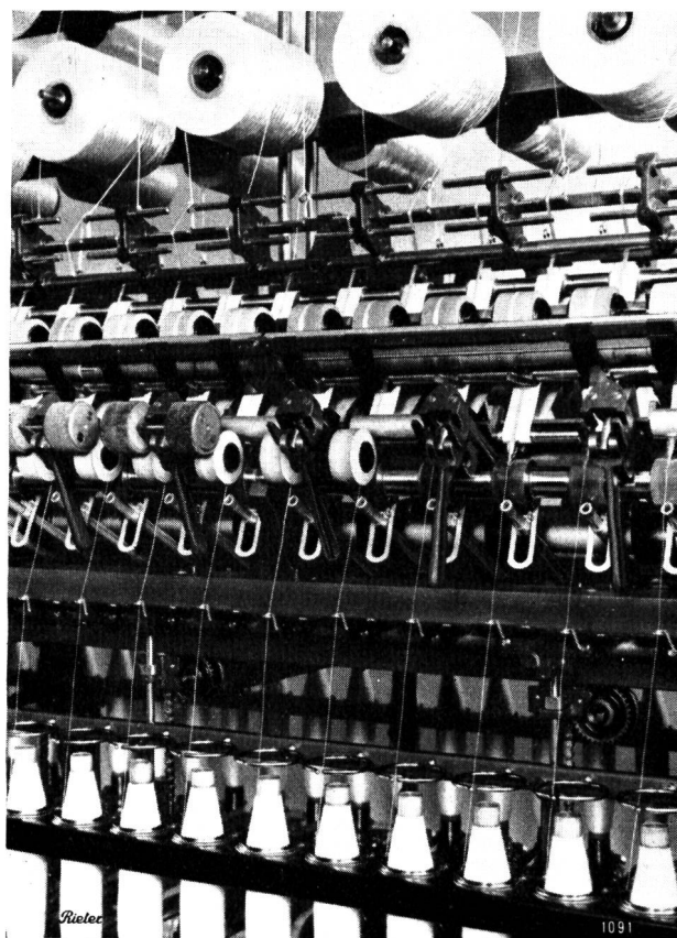
Rieter Cutdrafil-Ringspinnmaschine, Streckwerk
