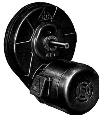
Durch die zusätzliche Lagerung der Stuhlwelle in der Hülle wird ein unveränderlicher Abstand zwischen Motor und Antriebswelle erzwungen. Im Gegensatz zu den früher üblichen Zahnradantrieben, bei denen der Motor gesondert auf einen Bock montiert wurde, ist hier ein stets genauer und von den mehr oder weniger starken Eigenbewegungen des Stuhles unabhängiger Zahneingriff gewährleistet. Der Verschleiß an Ritzeln wird hierdurch denkbar gering gehalten.
