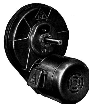
Durch die zusätzliche Lagerung der Stuhlwelle in der Häube wird ein unveränderlicher Abstand zwischen Motor und Antriebswelle erzwungen. Im Gegensatz zu den früher üblichen Zahnradantrieben, bei denen der Motor gesondert auf einen Bock montiert wurde, ist hier ein stets genauer und von den mehr oder weniger starken Eigenbewegungen des Stuhles unabhängiger Zahneingriff gewährleistet. Der Verschleiß an Ritzeln wird hierdurch denkbar gering gehalten.
