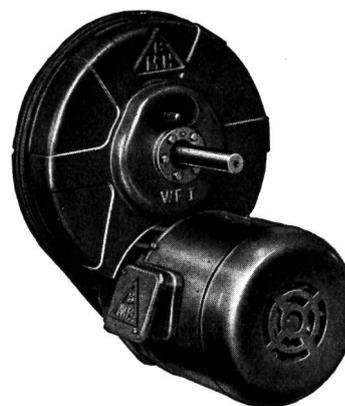
Durch die zusätzliche Lagerung der Stuhlwelle in der Haube wird ein unveränderlicher Abstand zwischen Motor und Antriebswelle erzwungen. Im Gegensatz zu den früher üblichen Zahnradantrieben, bei denen der Motor gesondert auf einen Bock montiert wurde, ist hier ein stets genauer und von den mehr oder weniger starken Eigenbewegungen des Stuhles unabhängiger Zahneingriff gewährleistet. Der Verschleiß an Ritzeln wird hierdurch denkbar gering gehalten.
