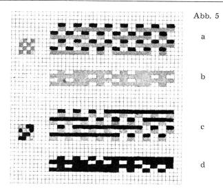
im Gewebe? Abb. 5a zeigt das schußweise auseinandergesetzte Ergebnis. Da sich im Stoff beim Anschlag der Lade der zweite Schuß auf den flottierenden ersten Schuß schiebt, ergibt sich für das Auge im Stoff das Bild der Bindung 5b.
