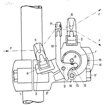
Querschnitt durch den Fadenwächter
