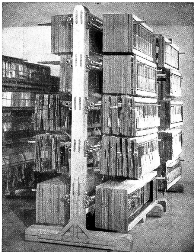
Geschirrkammer mit der Grob-Geschirr-Aufhängevorrichtung und den Grob-Leichtmetall-Webeschäften
