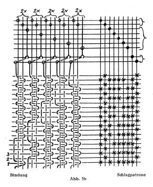
faden arbeitet. Die Grundfäden arbeiten in glatter Leinwandbindung und sind auf die beiden hintersten Schäfte im Grundgeschirr eingezogen. Die Dreherfäden kommen dem Muster entsprechend auf besondere Grundschäfte und passieren dann die haarnadelförmigen
