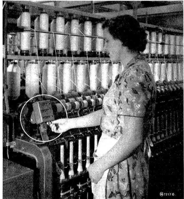
Abb. 3 — Auf einer Ringspinnmaschine montierter Produktionszähler für Dreischichtbetrieb.
