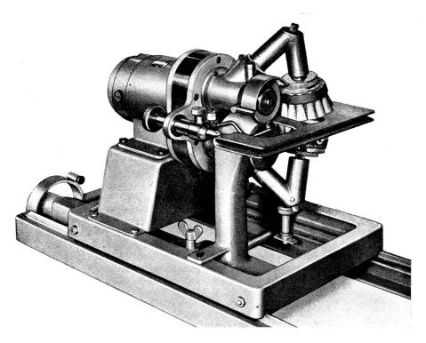
GARA-Fadenschneide-Apparat auf Laufschiene
