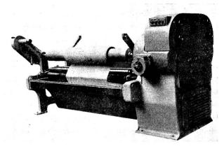
Ansicht des Jiggers. Am Gehäuse der Regulierknopf zur Festlegung der Durchzugslänge und entsprechenden Einstellung der automatischen Reversiervorrichtung
