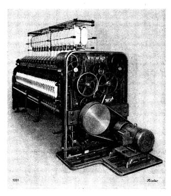
Ringspinnmaschine 44 mit Monocoup-Zentralschmierung
