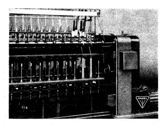
Großkopsmaschine Modell B 100/QD 4 mit Oberzylinder- und Spindelabstellung für die Herstellung wollener und baumwollener Strick- und Häkelgarne 2-8 fach
