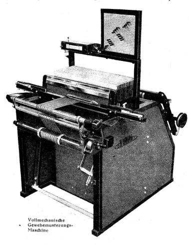
Schildknecht ist nichts geändert worden. Die Wirkungsweise bleibt somit dieselbe wie beim bisherigen Handmodell, dagegen hat die Leistungsfähigkeit durch die Mechanisierung eine entsprechende Steigerung erfahren. Die Maschine arbeitet mit 82 Schuß je Minute. Durch ihre geschlossene Bauart macht diese kleine Musterungsmaschine, auf welcher alle Materialien verarbeitet werden können, einen recht gefälligen Eindruck.
