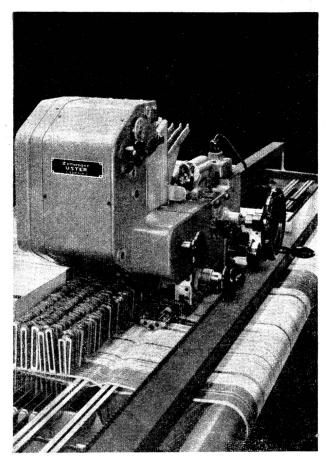
Automatische Lamellen-Steckmaschine "USTER"
