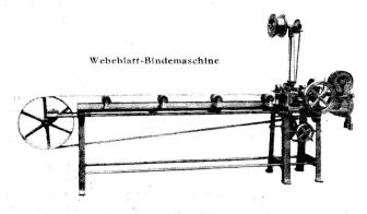
Neben der Blattbindemaschine werden auch noch alle übrigen unentbehrlichen Hilfsgeräte für die Herstellung von Webeblättern gezeigt, wie Drahtfederwind-Maschine, Drahtmeß-Maschinchen zur ganz genauen Feststellung der Dicke des Bindedrahtes, sowie ein elektrischer Blattgießofen.
