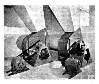
Saugzentrale mit zwei Ventilatoren für eine Sulzer-Fadenabsauganlage von 17400 Spindeln
