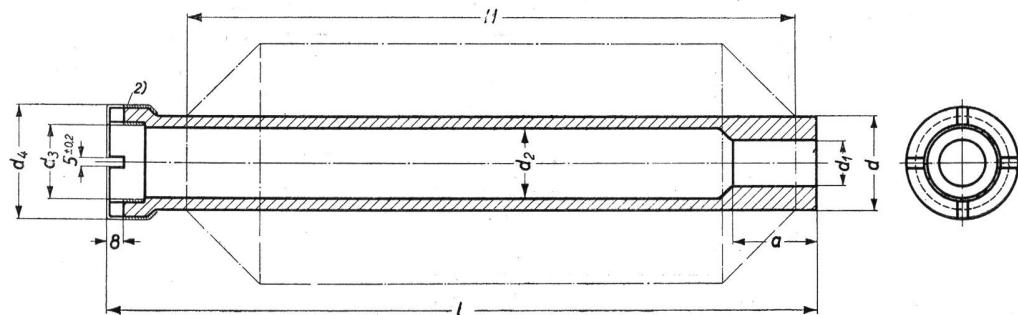
Bezeichnung einer Flyerhülse für einen Hub von 225 mm, einer Länge  $l = 265$  mm und einem Durchmesser  $d = 40$  mm:**Flyerhülse Hub 225 VSM ...<sup>1)</sup> <sup>2)</sup>**
