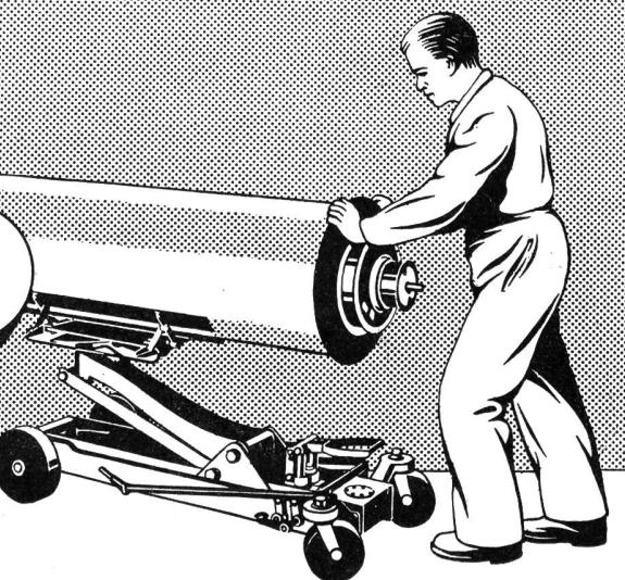
Der **hydraulische Kettbaum-Transport- und Hubwagen** spart Personal. Ein Mann genügt zum Einsetzen und Herausheben sowie Befördern selbst der schwersten Kettbäume. Der Wagen ist ausserordentlich praktisch und beweglich und von allen Seiten leicht zu bedienen. Normal- und Spezialmodelle gestatten die Anpassung an die jeweiligen Bedürfnisse. Bitte verlangen Sie den ausführlichen Prospekt.
