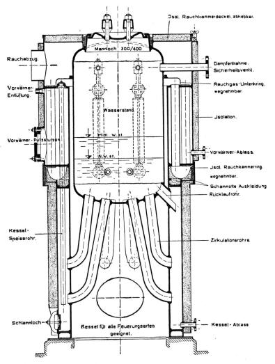
Fig. 2 Senkrechter Schnitt durch einen Feuerbüchs-Röhren-Dampfkessel Bauart H. E. Witz & Bertrams AG
