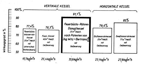
Normale stündliche Dauerleistung in kg Dampf pro m² Kesselheizfläche
